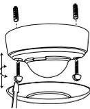
Le détecteur doit être monté sur une surface plane et solide. Enlever la colerette, avant le montage en dévissant d'env. 5° dans le sens inverse des aiguilles d'une montre et la retirer.
