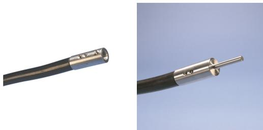
Le conducteur de descente isolé est un câble de descente, spécialisé dans la protection contre la foudre, qui peut être soumis, pendant le fonctionnement, à des courants de choc supérieurs à 100 kA et à des tensions allant jusqu'à 700 kV. L'ISODC a été conçu et testé pour contrôler la distance de séparation et l'arc. Une couche extérieure semi-conductrice sert à limiter au maximum les gradients de potentiel en cas de foudre. L'ISODC est proposé avec un noyau en cuivre ou en aluminium.
