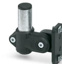
Console pour profilé en aluminium 40 mm, orientable avec kit de fixation, logement pour support de boîtier d'un diamètre de 30 mm, matériau : polycarbonate PC renforcé en fibres de verre, noir et aluminium, 270 g
