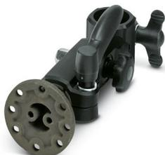
Support de boîtier 140,5 mm, pour charge max. de 10 kg, avec articulation sphérique et plaque de fixation 60 mm, orientable en pas de 15°, pour console murale/pour profilés 30 mm, matériau : polycarbonate PC renforcé en fibres de verre, noir et aluminium anodisé noir, 342 g
