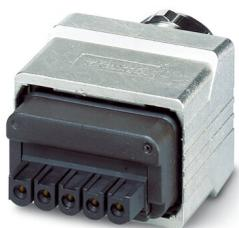
Connecteur de puissance, indice de protection: IP65, nombre de pôles: 5, matériau: Zinc coulé sous pression, type de raccordement: Raccordement à ressort, section raccordable: AWG 18- 13, sortie du câble: droit, coloris: argent
