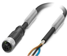
Câble pour capteurs/actionneurs, 3-pôles exempt d'halogène, blindé (Advanced Shielding Technology), extrémité libre, sur Connecteur femelle droit M12, détrompage: A, longueur de câble: 20 m
