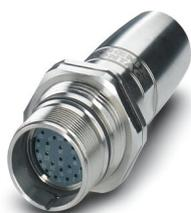
Traversée face arrière, droit, Verrouillage à vis, M27, nombre de pôles: 26, type de contact: Connecteur femelle, Joint torique axial, Fixation centrale, blindé: oui, indice de protection: IP 67, une fois enfiché, plage de diamètre de câble: 2 mm ... 14,5 mm, nombre de pôles: 26, type de raccordement: Raccordement à sertir, série: HC
