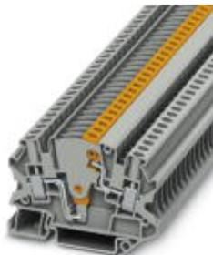
Bloc de jonction de sectionnement pour essais, Mode de raccordement: Raccordement vissé, Nombre de connexions: 2, Section :0,14 mm<sup>2</sup> - 6 mm<sup>2</sup>, AWG: 26 - 10, Largeur: 6,2 mm, Coloris: gris, Type de montage: NS 35/7,5, NS 35/15
