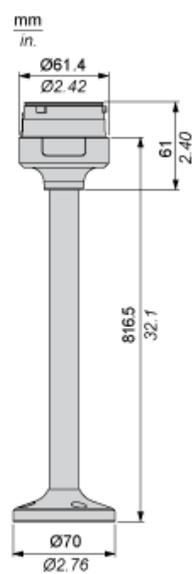
Montage des colonnes de signalisation modulaires
