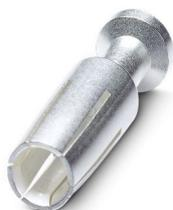
Contact à sertir, diamètre de contact: 4 mm, tournés, Connecteur femelle, matériau de contact: Alliage de cuivre, surface des contacts: plaqué argent, section raccordable: 10 mm<sup>2</sup> ... 10 mm<sup>2</sup>, AWG 8
