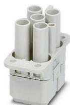
Élément de contact, nombre de pôles: 4+2+PE, taille: COM, contacts de puissance: 4, contacts de commande: 2, Connecteur femelle, Raccordement à sertir, 250 V, 40 A, 0,14 mm<sup>2</sup> ... 2,5 mm<sup>2</sup>, application: Puissance / signal
