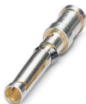
Contact à sertir, diamètre de contact: 1,6 mm, tournés, Connecteur femelle, matériau de contact: Alliage de cuivre, sans plomb, surface des contacts: plaqué argent, section raccordable: 1,5 mm<sup>2</sup> ... 1,5 mm<sup>2</sup>, AWG 16
