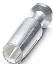
Contact à sertir, diamètre de contact: 4 mm, tournés, Connecteur femelle, matériau de contact: Alliage de cuivre, sans plomb, surface des contacts: plaqué argent, section raccordable: 2,5 mm<sup>2</sup> ... 2,5 mm<sup>2</sup>, AWG 14
