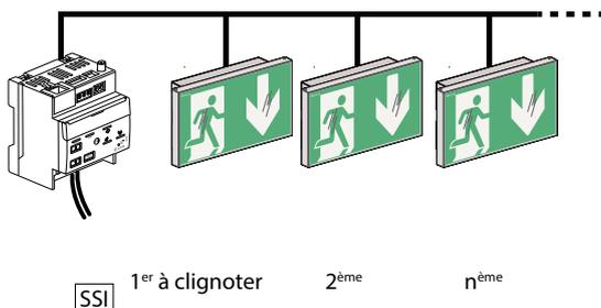
Ce paramétrage doit être fait avec la passerelle de configuration réf. 140 132 et l'application CloseUp. Cette action permet d'attribuer un numéro d'ordre qui indique la position du bloc dans la file.
