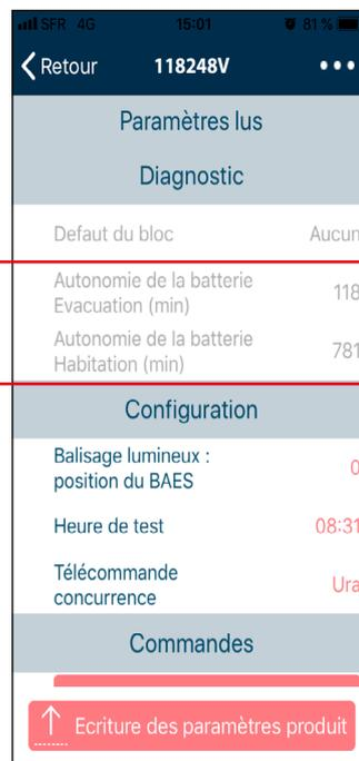
Ce paramètre permet de visualiser la durée de l'autonomie des batteries (mesurée en minute) lors du dernier test trimestriel.
