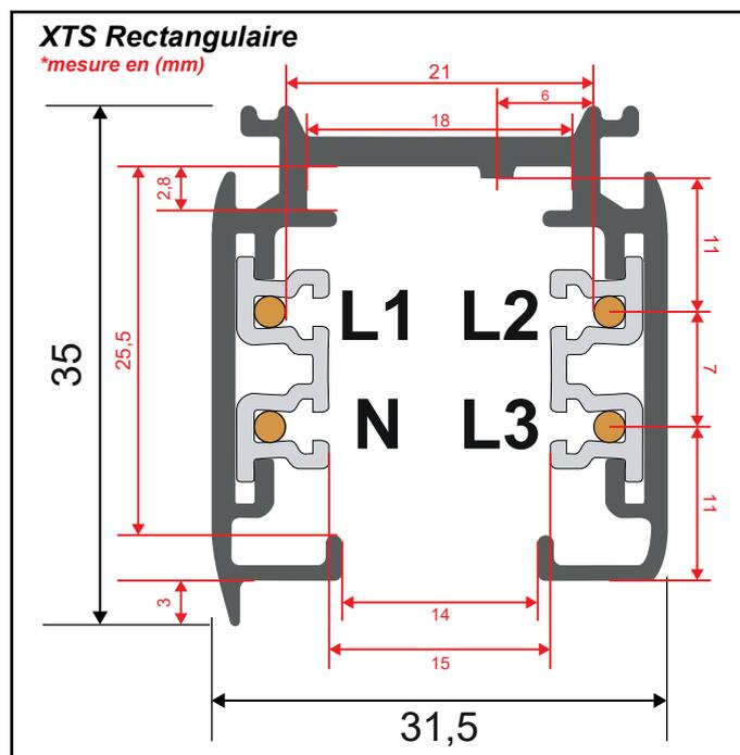
Le rail électrifié XTS est distribué en longueurs standards. Cependant, il peut être coupé selon le désir de la longueur, avec une scie à métaux ou une scie circulaire pour aluminium. Après avoir coupé le rail XTS, les conducteurs en cuivre doivent être repliés à 90 °.
