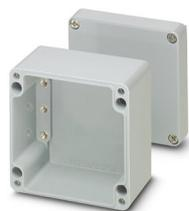
Boîtier vide, matériau: Polyester renforcé à la fibre de verre, gris petit-gris RAL 7000, 120 mm x 220 mm x 91 mm, type de verrouillage: Couvercle vissé
