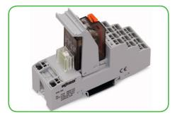
Embase enfichable avec indication d'état intégrée, diode de roue libre et sectionnement manuel. 4 RT / 5A. Hauteur du relais 35 mm.
