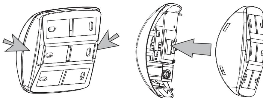
Placer la pile dans le sens adapté (pôle « + » du côté « + » et pôle « - » du côté « - »).
