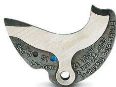
Lame de rechange pour CUTFOX 50 STEEL, pour le cuivre et l'aluminium jusqu'à 50 mm de Ø, pour câbles CU/AL armés en acier, pour câbles métalliques souples jusqu'à 12 mm de diamètre
