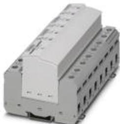
Parafoudre et parasurtenseur combinés enfichables, selon type 1+2/classe I+II, pour réseaux électriques triphasés, avec N et PE séparés (L1, L2, L3, PE, N).
