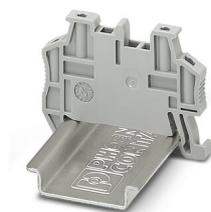
Crampon terminal à montage rapide, classe d'inflammabilité V0 selon UL 94, pour profilé NS 35/7,5 ou NS 35/15, repérage avec UC-TM 5, UC-TMF 5, KLM 2, KLM3 et KML3L, portabilité pour FBS...5, FBS...6, KSS 5, KSS 6, largeur : 5,15 mm, coloris : gris
