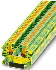
Bloc de jonction pour conducteur de protection, nombre de connexions: 2, type de raccordement: Raccordement Push-in, Section de référence: 2,5 mm<sup>2</sup>, section : 0,14 mm<sup>2</sup> - 4 mm<sup>2</sup>, type de montage: NS 35/7,5, NS 35/15, coloris: vert/jaune
