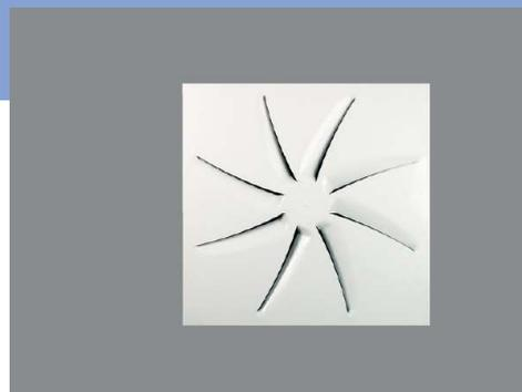
Les diffuseurs à jet hélicoïdal de la série OTO ont été conçus pour être utilisés dans des systèmes de ventilation, chauffage et climatisation. Ils peuvent être montés dans les faux plafonds ou suspendus au plafond dans des locaux de 2,5 m à 4 m de haut avec un différentiel de température pouvant aller jusqu'à 12°C.
