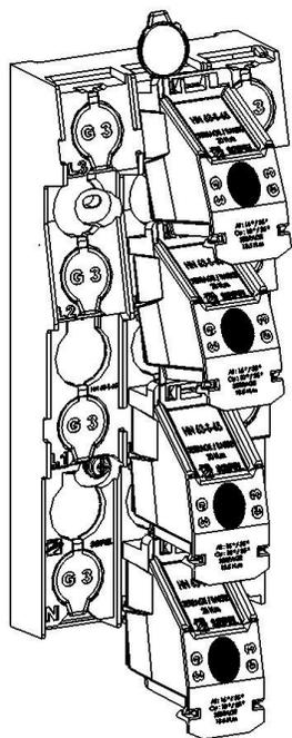
**A** - Fixer les bornes de raccordement sur la platine sur un pas de 50mm:
