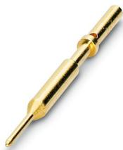
Contact à sertir, Mâle, tournés, diamètre de contact: 0,6 mm, zone de sertissage: 0,34 mm<sup>2</sup> ... 0,5 mm<sup>2</sup>, Produit de remplacement selon RoHS II sans exception 6c (Pb < 0,1 %) référence : 1242312
