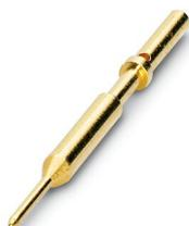
Contact à sertir, Mâle, tournés, diamètre de contact: 0,6 mm, zone de sertissage: 0,06 mm<sup>2</sup> ... 0,25 mm<sup>2</sup>, Produit de remplacement selon RoHS II sans exception 6c (Pb < 0,1 %) référence : 1242311
