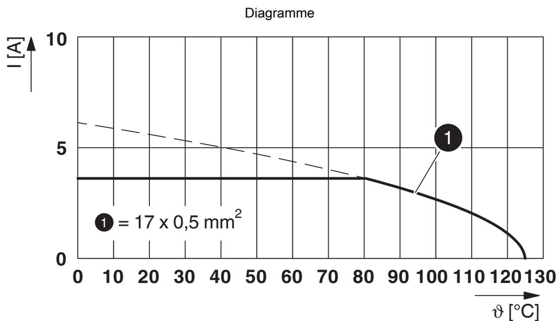
$I$  = intensité,  $\vartheta$  = température ambiante, 17x 3,6 A
