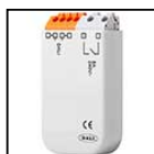
S.2495 DALI RELAY SWITCH pour ON-OFF (NON GRADABLES) 230V APPAREILS Tous les appareils fonctionnant à 230V non gradables (ON-OFF) peuvent être contrôlés ON-OFF avec le système DALI avec les accessoires interfaces suivants. Il s'en suit que l'appareil sera contrôlé à distance dans le seul mode ON-OFF et non pas en mode gradable. IP20 Max nominal load 1000VA Max switching current 8A Max inrush current 80A Dimensions 32,5mm x 15mm x 58,5mm
