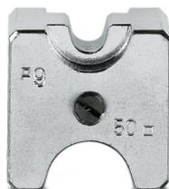
Matrice (partie inférieure) pour CRIMPFOX-C120, pour cosses non isolées (DIN 46234) 6 + 50 mm<sup>2</sup>, sertissage indent
