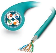
Câble réseau, Ethernet, 8 fils, blindé, PUR exempt d'halogène, bleu d'eau RAL 5021, AWG 26, 4x 2x 0,14 mm<sup>2</sup>, longueur : 500 m
