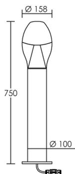
Corps aluminium extrudé/Diffuseur polycarbonate transparent. **LED SMD CITIZEN**. Précâblée avec raccord, code **0743**, IP68.
