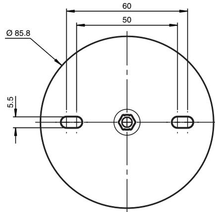
Visser le dispositif sur une surface de montage plane à l'aide de deux vis de fixation M4.
