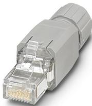
Connecteur RJ45, type: RJ45, indice de protection: IP20, nombre de pôles: 8, 1 Gbit/s, CAT5, matériau: Plastique, type de raccordement: Raccordement autodénudant, section raccordable: AWG 26- 23, sortie du câble: droit, coloris: gris signalisation A RAL 7042, Ethernet
