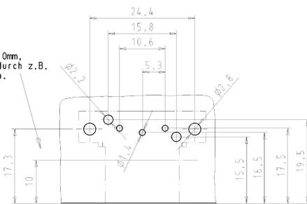
Überstand des Steckverbinders max. 10mm, dahinter muss die Berührsicherheit durch z.B. eine Abdeckung sichergestellt werden.
