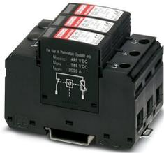
Parafoudre pour systèmes à tension continue PV à 2 pôles, isolés et mis à la terre de 1 000 V DC, pour montage sur rail DIN, élément de base à 3 pôles, trois éléments de protection enfichables, avec contrôle de la température, affichage de l'état sur chaque connecteur.
