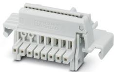
Connecteurs sur profilé, coloris: gris clair, intensité nominale: 6 A (contacts parallèles), tension de référence (III/2): 32 V, nombre de pôles: 8, pas: 2,54 mm, montage: Montage sur profilé, verrouillage: sans, type de fixation: sans, type de conditionnement: emballé dans un carton, Article avec contacts dorés, connecteur de bus pour le raccordement de boîtiers électroniques, 8 contacts parallèles
