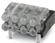
Fibre optique multiple à protection contre les surexpositions, passif, rigide, utilisable pour les familles de boîtiers ME, ME MAX, ME-IO, ME PLC et EH (traitement du boîtier nécessaire)
