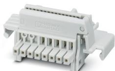
Connecteurs sur profilé, coloris: gris clair, intensité nominale: 6 A, 4 A (contacts parallèles) (Contacts série), tension de référence (III/2): 32 V, nombre de pôles: 8, pas: 2,54 mm, montage: Montage sur profilé, verrouillage: sans, type de fixation: sans, type de conditionnement: emballé dans un carton, Article avec contacts dorés, connecteur de bus pour le raccordement de boîtiers électroniques, 6 contacts parallèles/2 contacts série
