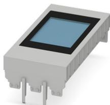
Boîtier électronique sur rail DIN, 10U partie supérieure, écran tactile résistif de 2,4" intégré, résolution: 320 x 240 Pixel(s), interface: 4-wire SPI half duplex, Capot, largeur: 56,88 mm, hauteur: 109,8 mm, profondeur: 29,5 mm, coloris: gris clair (7035)
