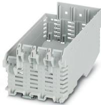
Boîtier électronique sur rail DIN, Partie inférieure du boîtier avec pied métallique de verrouillage, avec fentes d'aération, largeur: 75,87 mm, hauteur: 120,6 mm, profondeur: 64,3 mm, coloris: gris clair (7035), connexion transversale: Connecteur de bus sur rail DIN (en option), nombre de pôles connecteur transversal: 5 ou 8
