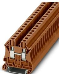
Blocs de jonction simple, tension nominale: 1000 V, intensité nominale: 41 A, nombre de connexions: 2, type de raccordement: Raccordement vissé, Section de référence: 6 mm<sup>2</sup>, section : 0,2 mm<sup>2</sup> - 10 mm<sup>2</sup>, type de montage: NS 35/7,5, NS 35/15, coloris: marron
