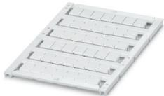
Repères pour blocs de jonction, à commander : sous forme de planche, blanc, impression selon les indications du client, type de montage: encliquetage dans la rainure de repérage élevée, pour bloc de jonction au pas de : 8,2 mm, surface utile: 7,6 x 10,5 mm, Nombre d'étiquettes: 42
