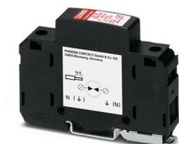
Parafoudre B de type 1 / classe I avec éclateur Arc-Chopping encapsulé et dispositif d'amorçage électronique, monocanal. Niveau de protection : 4 kV. Largeur boîtier : 17,5 mm (1TE)
