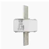
**Cartouche fusible, grande vitesse, 1250 A, AC 690 V, size 3, 76 x 76 x 150 mm, aR, IEC, indicateur de fusion simple**
