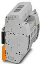
Connecteur de test, tension nominale: 400 V, nombre de connexions: 8, nombre de pôles: 4, type de raccordement: Raccordement vissé, 1er étage, Section de référence: 6 mm<sup>2</sup>, section : 0,2 mm<sup>2</sup> - 10 mm<sup>2</sup>, type de montage: NS 35/7,5, coloris: gris
