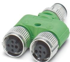
Répartiteur en Y, 4-pôles, connecteur mâle droit M12 SPEEDCONNec, détrompage: A, sur Connecteur femelle droit M12 SPEEDCONNec, détrompage: A et Connecteur femelle droit M12 SPEEDCONNec, détrompage: A
