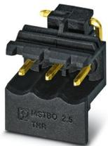
Embase de circuit imprimé, coloris: noir, surface des contacts: Or, type de contact: Mâle, nombre de pôles: 3, gamme d'articles: MSTBO 2,5/..-G1L THR Au, pas: 5 mm, montage: Soudage THR, plan des broches: Brochage linéaire, longueur de broche [P]: 2,5 mm, nombre de picots par potentiel: 1, système débrochable: COMBICON MSTB 2,5, type de conditionnement: Sangle en largeur de 44 mm, Article avec sortie de broche latérale
