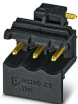
Embase de circuit imprimé, coloris: noir, surface des contacts: Or, type de contact: Mâle, nombre de pôles: 3, gamme d'articles: MSTBO 2,5/..-G1R THR Au, pas: 5 mm, montage: Soudage THR, plan des broches: Brochage linéaire, longueur de broche [P]: 2,5 mm, nombre de picots par potentiel: 1, système débrochable: COMBICON MSTB 2,5, type de conditionnement: Sangle en largeur de 44 mm, Article avec sortie de broche latérale droite
