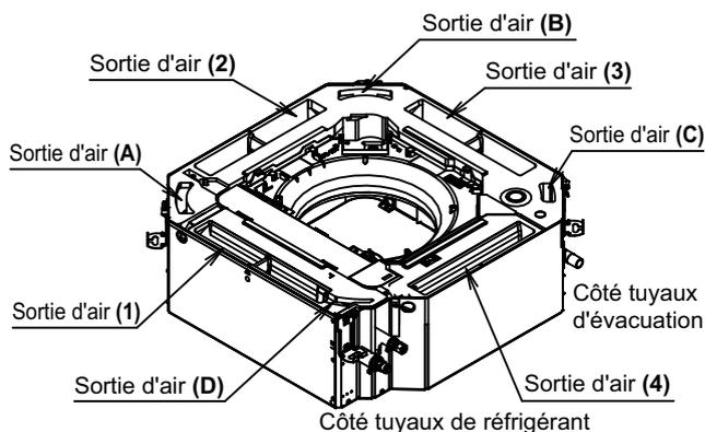
Préparez le matériel d'étanchéité et le ruban pour fixer le matériel d'étanchéité en fonction de la sortie d'air (1) à (4) devant être fermée.
