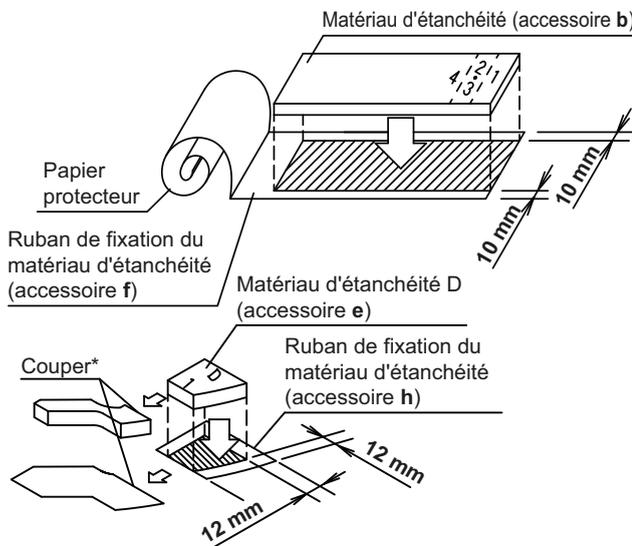
\* Ne coupez que si vous souhaitez fermer uniquement la sortie d'air (1). Ne coupez pas si vous souhaitez fermer à la fois la sortie d'air (1) et la sortie d'air (D).
