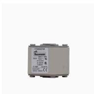
Cartouche fusible, grande vitesse, 500 A, AC 690 V, size 1, 53 x 69 x 51 mm, aR, IEC, UL, filetage US, corps carré avec contacts affleurants
