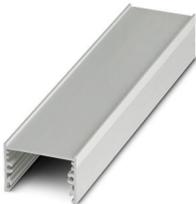
Boîtier pour profilé extrudé, Montage vissé, Capot profilé, coloris: couleurs aluminium, largeur: 45,6 mm, largeur du profilé (intérieure): 42 mm, largeur du profilé (extérieure): 45,6 mm, longueur: 42,5 mm, profondeur: 28,1 mm
