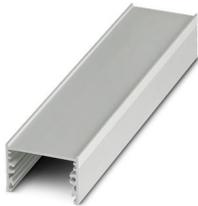
Boîtier pour profilé extrudé, Montage vissé, Capot profilé, coloris: couleurs aluminium, largeur: 45,6 mm, largeur du profilé (intérieure): 42 mm, largeur du profilé (extérieure): 45,6 mm, longueur: 235 mm, profondeur: 28,1 mm
