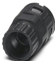
Adaptateur pour gaines annelées, avec filetage intérieur, pour le raccordement de gaines annelées à des raccords vissés HEAVYCONNEC EVO M25 en plastique ou à un boîtier en plastique ADVANCE M25, droit, noir, IP66.
