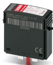
Fiche de protection antisurtension de type 2 avec montage en série composé d'une varistance haute performance et d'un éclateur à gaz pour élément de base VAL-MS, surveillance thermique, signalisation optique de défaut. Modèle : 350 V AC à pouvoir de décharge courant de foudre augmenté.
