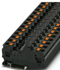
Bloc de jonction-fusibles, type de fusible: Verre / Céramique / ..., type de fusible: G / 5 x 20, tension nominale: 1000 V, intensité nominale: 10 A, type de raccordement: Raccordement Push-in, Section de référence: 6 mm<sup>2</sup>, section : 0,5 mm<sup>2</sup>- 10 mm<sup>2</sup>, type de montage: NS 35/7,5, NS 35/15, coloris: noir
