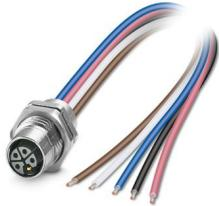
Connecteur d'appareil face arrière, Puissance, 5-pôles, connecteur femelle, M12, détrompage: L, sur extrémité libre, Montage face arrière, M16 x 1,5, Cordons individuels, longueur de câble: 0,5 m, 2,50 mm<sup>2</sup>, Cordon PEX, Produit de remplacement selon RoHS II sans exception 6c (Pb < 0,1 %) référence : 1238575
