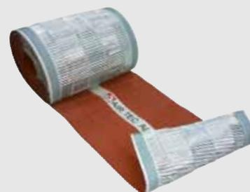
Ces closoirs ventilés ultra résistants comportent deux bandes adhésives de types Butyl qui leur permettent d'adhérer parfaitement au support. Les closoirs stoppent les infiltrations d'eau, de poussière ou de neige poudreuse. Souples et malléables, les 4 dimensions permettent de s'adapter à tous les toits tuiles, quel que soit l'importance de l'onde de la tuile.
