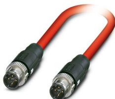
Câble sercos III pré-équipé, blindé, quarte en étoile, AWG 22 flexible (7 fils), RAL 3020 (rouge signalisation), connecteur mâle M12, SPEEDCONNEC, 4 pôles sur connecteur mâle M12, SPEEDCONNEC, longueur : 3 m
