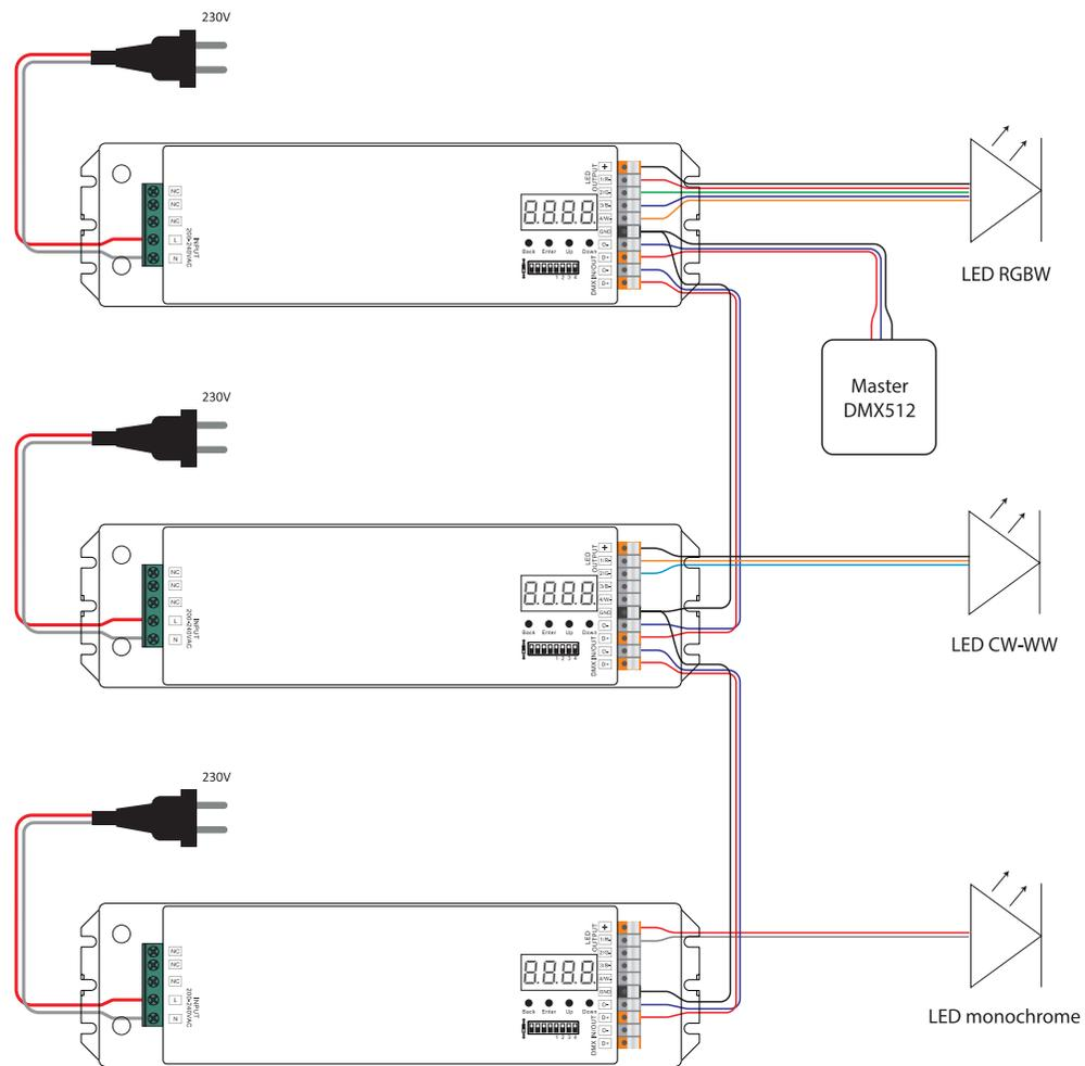
**Remarque :** lorsque le canal DMX est réglé sur CH01 et que 4 canaux de sortie PWM sont câblés simultanément aux LEDs, il convient de s'assurer que le courant de fonctionnement des charges LED ne dépasse pas 1100mA.
