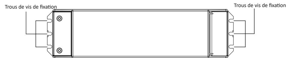
**Remarque :** lors du montage du driver, choisir l'un des trois trous de vis de fixation pour fixer une vis à chaque extrémité.
