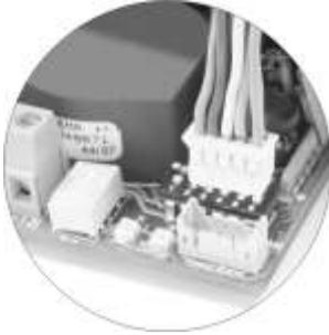
Brancher le câble de connexion des poussoirs au connecteur CN6 du circuit microprocesseur EL500/V2PLUS. Ce câble dispose de 10 fils conducteurs (P1 à P8, B et CP) pour la connexion de poussoirs ou modules d'extension EL516SE.
