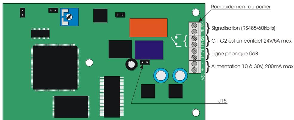
Le raccordement se fait par un bornier à vis intégré dans le MPP CASI (1mm<sup>2</sup> maxi). La commande de gâche fournit un contact sec unipolaire 24 volts/1A (NO par défaut et modifiable par programmation).
