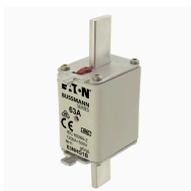
**Cartouche fusible, Basse tension, 63 A, AC 500 V, 120 kA, NH1, gL/gG, IEC, à double indicateur de fusion, pattes d'extraction conductrices**
