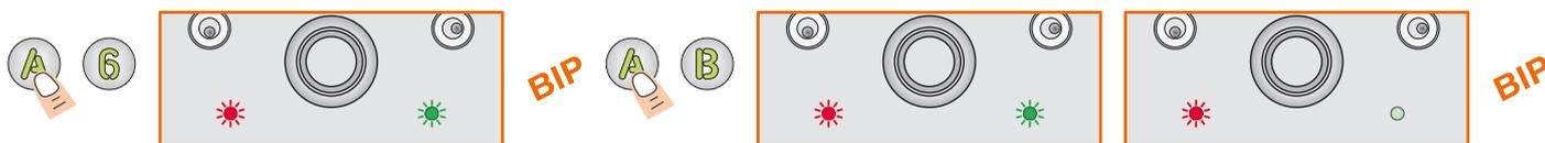
Lorsque les leds sont éteintes, le clavier codé est retourné en configuration d'usine.
