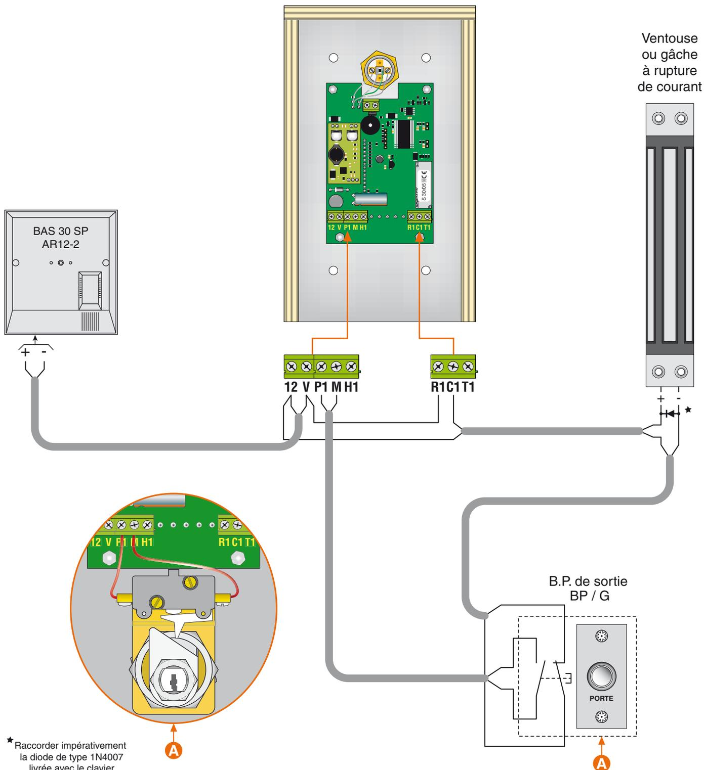
\* Raccorder impérativement la diode de type 1N4007 livrée avec le clavier
