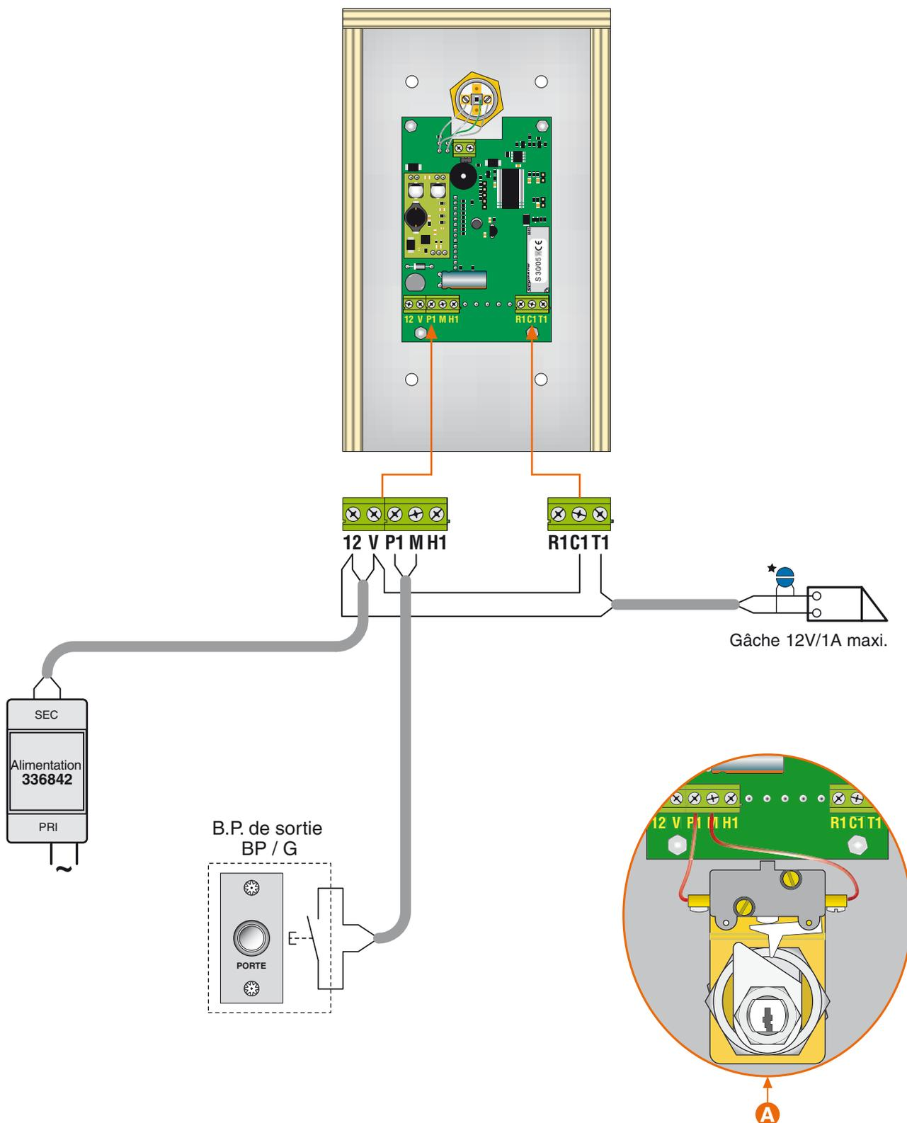
\* Si autre produit que Bticino raccorder impérativement la varistance sur la gâche électrique livrée avec le clavier codé
