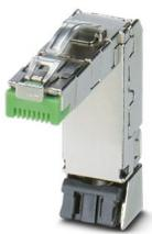
Connecteur RJ45, type: RJ45, indice de protection: IP20, nombre de pôles: 8, 1 Gbit/s, CAT5, matériau: Métal, type de raccordement: Raccordement autodénudant, section raccordable: AWG 26- 24, sortie du câble: coudé, Ethernet
