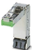
Connecteur RJ45, type: RJ45, indice de protection: IP20, nombre de pôles: 6, 100 Mbit/s, CAT5 (CEI 11801:2002), matériau: Métal, type de raccordement: Raccordement autodénudant, section raccordable: AWG 26- 24, sortie du câble: coudé, Haute résistance aux vibrations ; blindage 360° ; thème One-Piece ; fabrication ne nécessitant pas d'outils spéciaux, VARAN
